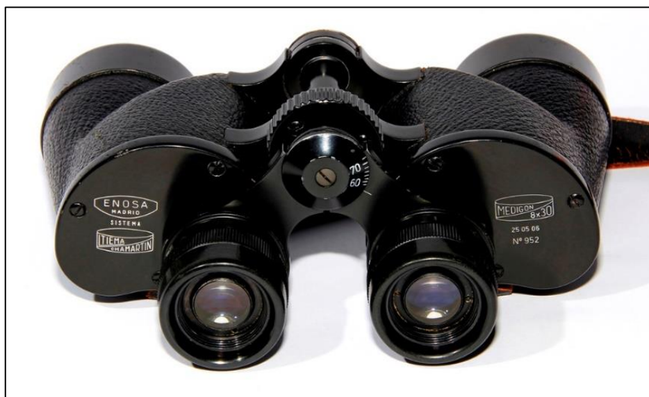
Figura 4: Prismáticos modelo Medigon 8x30 fabricados por ENOSA. En el brazo del ocular izquierdo llevan estampada la leyenda: ENOSA-MADRID y debajo LYTIEMA-CHAMARTIN 8 .
